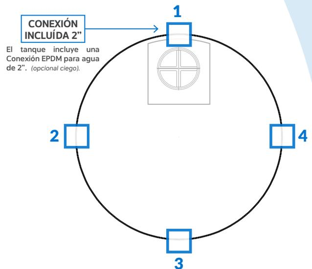
El tanque incluye una Conexión EPDM para agua de 2". (opcional ciego).
